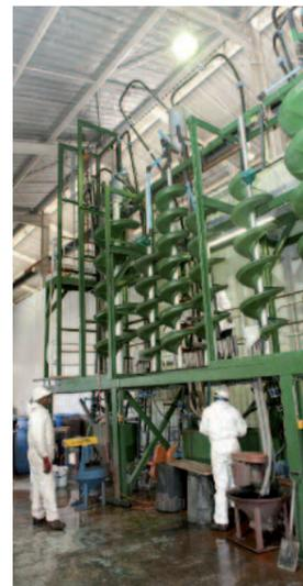
En métallurgie, la gravimétrie désigne un ensemble de techniques permettant de séparer les matériaux, en fonction de la différence de poids et de densité de ces derniers.
