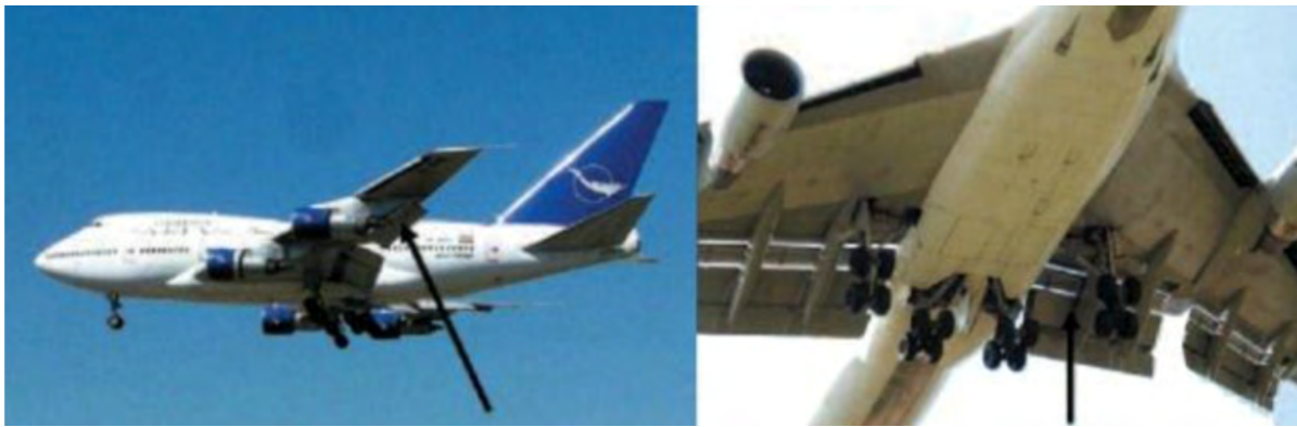
Les volets et ailerons d'avion ont des systèmes de contrepoids en alliage lourd de tungstène (source : https://itia.info )
