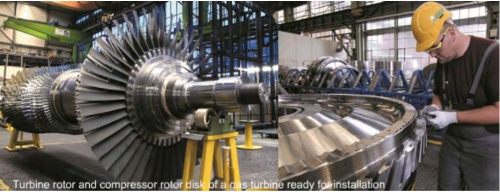
Turbines en acier renforcé au tungstène (1 à 2%) pour augmenter la résistance à la chaleur et la déformation (source : https://itia.info )
