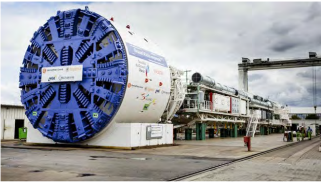
Tunnelier du Grand Paris dont les dents sont en carbure de tungstène (source : société du Grand Paris)
